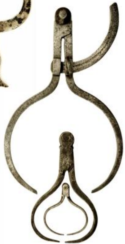
Il compasso è un antichissimo strumento geometrico da disegno, già in uso presso i greci, che per primi definirono i principi della geometria piana. Numerosissime sono le varianti che ha subito lo strumento in funzione dell'uso specifico nelle varie attività dell'uomo. A sinistra: compassi da disegno, a destra, campassi da misura in ferro in alto al centro un "maitre à danser".
