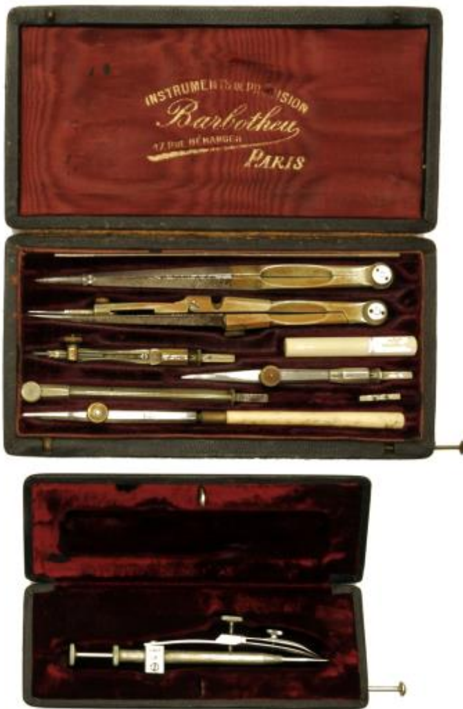
Il compasso è un antichissimo strumento geometrico da disegno, già in uso presso i greci, che per primi definirono i principi della geometria piana. Numerosissime sono le varianti che ha subito lo strumento in funzione dell'uso specifico nelle varie attività dell'uomo. A sinistra: compassi da disegno, a destra, campassi da misura in ferro in alto al centro un "maitre à danser".
